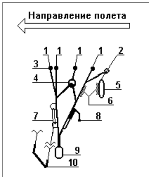
Рис. 55. Пример конструкции свободных концов.
