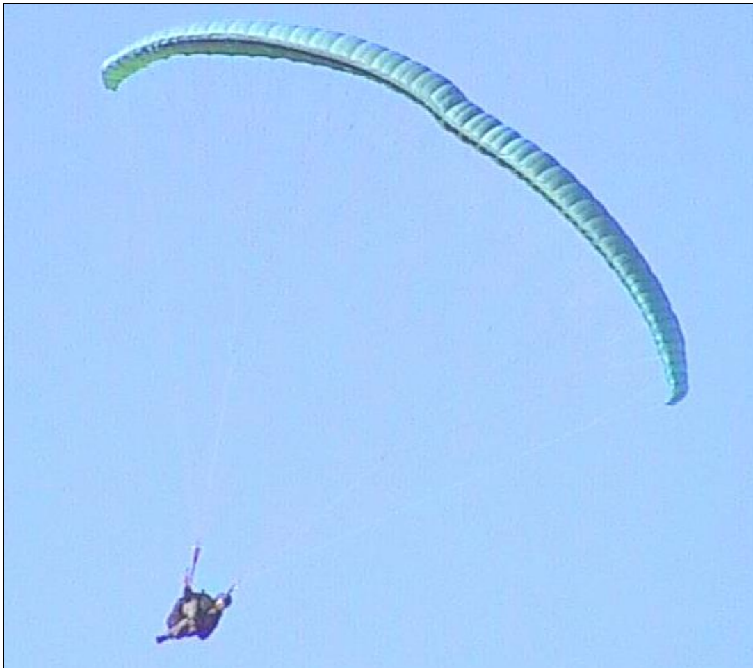
Рис. 67. Выполнение разворота балансирным способом. Обратите внимание на характерный изгиб в центре купола, возникающий из-за перекашивания свободных концов.
