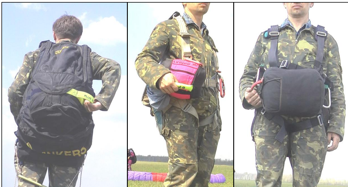
Рис. 99. Парашют встроен в подвесную систему.
