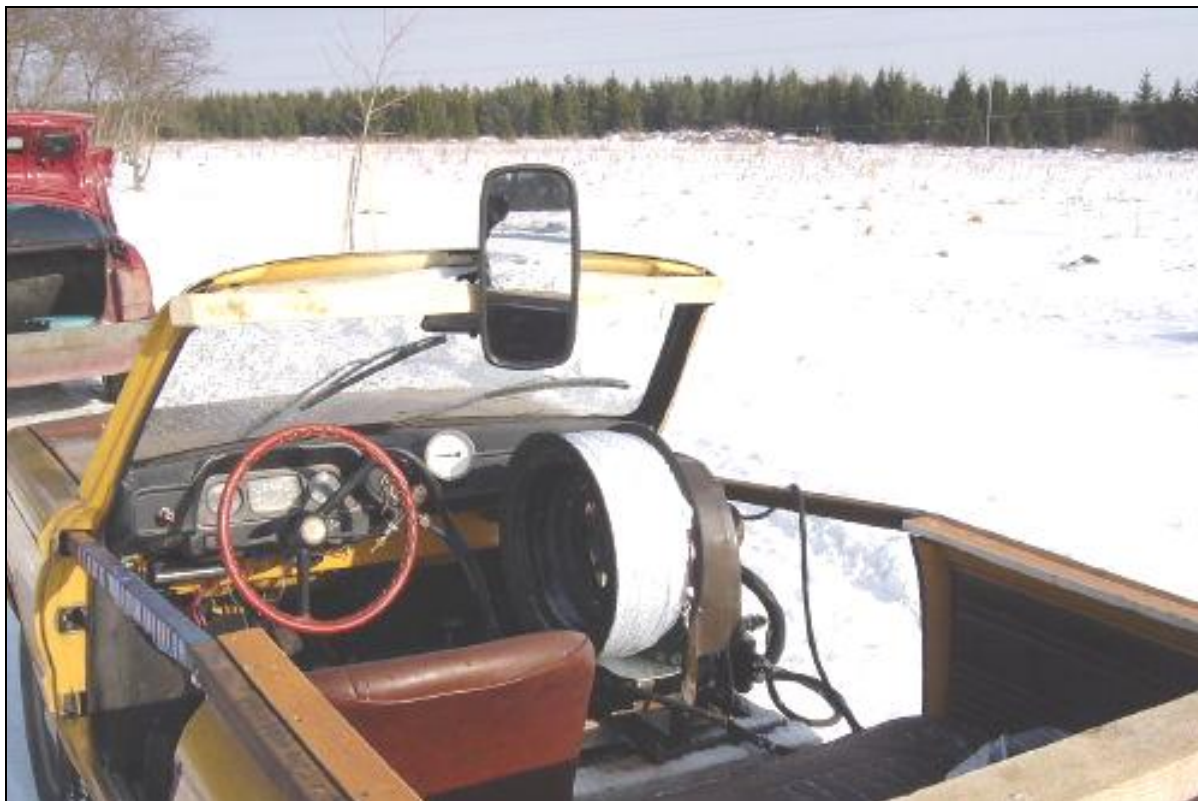
Рис. 82. Пассивная гидравлическая лебедка Николая Селиванова.
